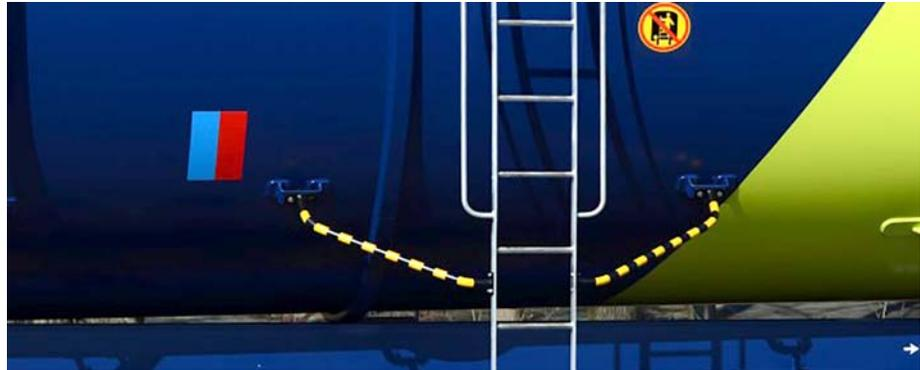
Bild 2.2: Aufkleber: Position der Armaturen
