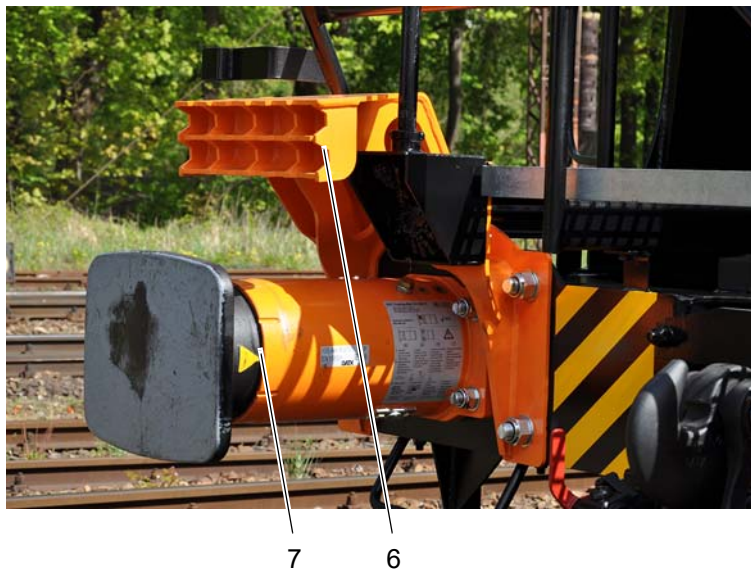
Bild 2.2: Crashpuffer mit Indikator
