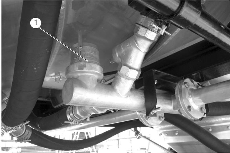
**Bild 6.8 – Einbauort Sicherheits-/ Vakuumventil**
