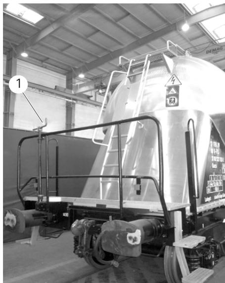
**Bild 4.5 – Handbremse**
