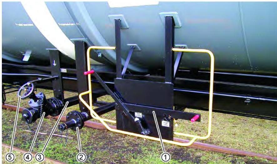
Bild 3.10: Untere Befüll- und Entleereinrichtungen Typ 1695
