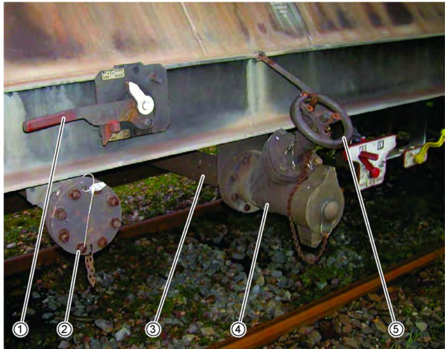
Bild 3.6: Untere Befüll- und Entleereinrichtungen Typ 1685
