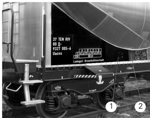
**Bild 4.9** – Halter für Warnschilder und Gefahrguttabeln
