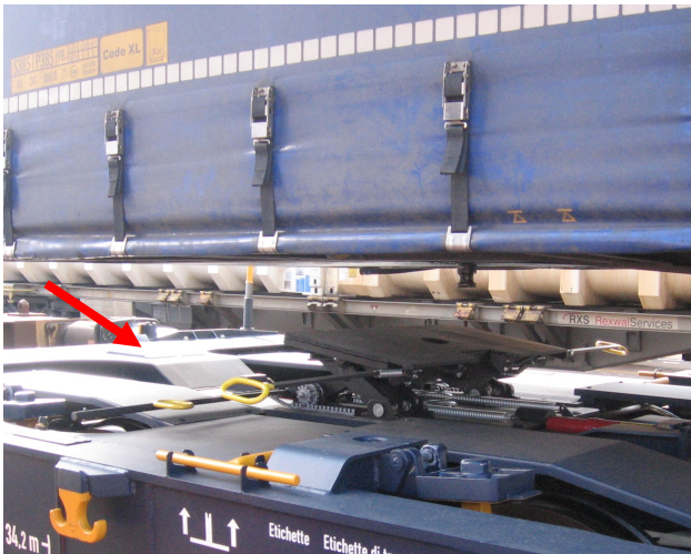
Sattelaufleger beim Beladungsvorgang (mit Rutschplatte)
