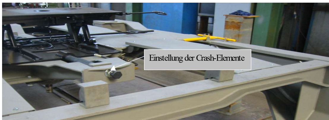
Stützbock mit Crash-Elementen
