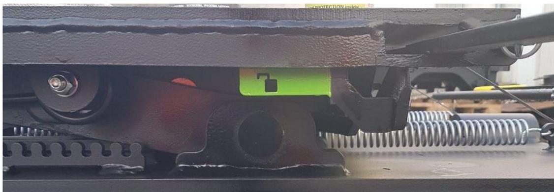
So lange wie die Anzeige (rot oder grün > Kundenabhängig) erkennbar ist, ist der Zugsattelzapfen nicht im Trichter. Erst wenn die Anzeige nicht mehr erkennbar ist, steckt der Sattelzapfen im Trichter.
